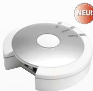
Adapter für die Konfiguration von HomeMatic-Komponenten über einen PC per LAN
